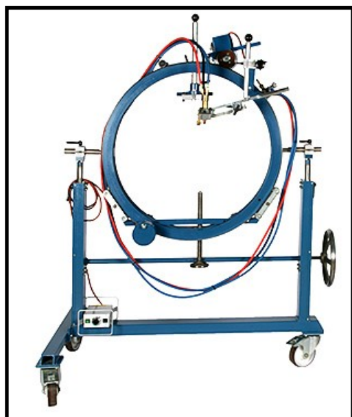
Rijgend onderstel met de RSG - brandsnijmachine erop gemonteerd.
