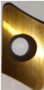
HSS - beschichtete Wendeschneidplatten in mehrere Formen und ALLE haben 2 Schneidkanten:
