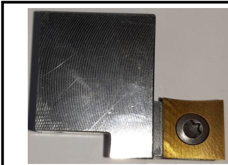
Halter zum GERADE AUSDREHEN vom Rohr (in einer Rohrplatte z.B.) mit Wendeschneidplatte 12 mm.
